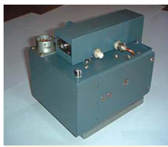
● Циклотронное защитное комбинированное приёмное устройство для бортовых авиационных радиолокационных систем.
