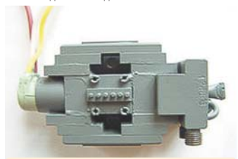
● Многолучевой усилительный кластрон импульсного действия для бортовых устройств малогабаритных бортовых радиолокаторов.
