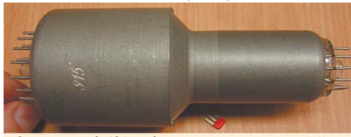
● Функциональная трубка ЛФ-9, разработанная группой конструкторов отдела № 130, устанавливалась в советских системах ПВО.
