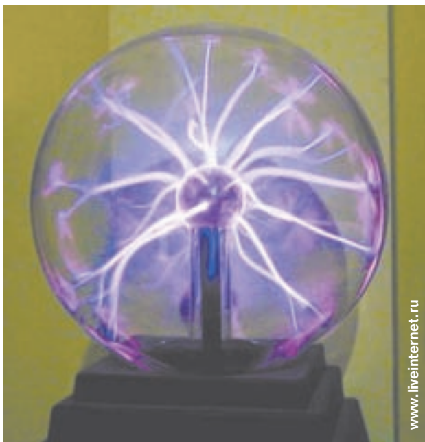
● Плазменная лампа – светильник в виде шара, в котором возникают миниатюрные молнии разных цветов. Это устройство было изобретено выдающимся сербским инженером Николой Теслой еще в 1894 году и стало прообразом современных газоразрядных источников света.
