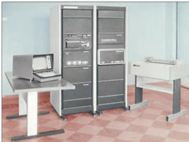
● Первый советский мини-компьютер СМ-4, совместимый с компьютером PDP-11 американской компании Digital Equipment Corporation (DEC).
